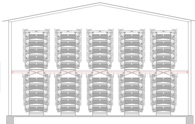
图 8 典型产蛋鸡舍横向剖面示意图 (9LDC-10 10层5列)
