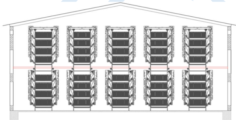
图 14 典型育雏育成鸡舍横向剖面示意图（9LDY-8 8层5列）
